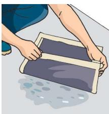
**Método manual (plástico):** coloque pedazos de plástico (mínimo 40x40cm) en diversos puntos del contrapiso. Sujete todo el borde del plástico con cinta adhesiva y espere 24 horas. Si el plástico "transpira" o si el contrapiso se queda más oscuro en esa área significa que el agua aún está evaporándose y, por tanto, el contrapiso está húmedo. Deje el local ventilado y repita la prueba algunos días después. Esta prueba no es precisa.
