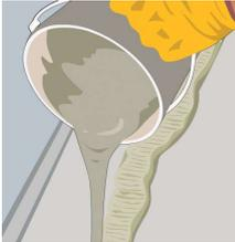
a. Comenzando del eje marcado previamente y utilizando una llana dentada A4, esparza el adhesivo siguiendo las informaciones de rendimiento para cada tipo de producto;
