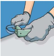
Debido al proceso de almacenamiento vertical, los bordes de los rollos sufren naturalmente pequeños daños, como abolladuras o impregnación de suciedad, abolladuras o impregnación de suciedad. Por eso, deben ser rellenos en por lo menos 1cm para mejorar la seguridad de la soldadura (fría o caliente). Este proceso puede ser hecho con un corta bordes o con estilete, ayudado por una tabla de metal.
