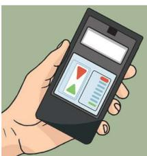
**Método digital:** utilizando un medidor por radiofrecuencia, coloque el aparato en una parte plana del contrapiso o pared. La interpretación de la lectura debe seguir la tabla inscrita en el aparato.
