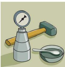
**Método CCM (carburo de calcio), Método CCM (carburo de calcio),** con utilización del aparato medidor "speed test", a través de la retirada de volúmenes de 3g, 6g o 12g, a una profundidad de 2 a 3cm. Para eso, utilice una mandarina y un cincel.
