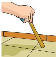
**6.2. Cerámico:** con juntas inferiores a 5mm. Antes de la aplicación de la masa de preparación o autonivelante es necesario el uso de un primer promotor de adherencia o una mano de adhesivo de doble contacto.
